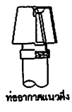
แบบระบายน้ำที่ท่อระบายอากาศเหล็กท่อ ( AVC )
